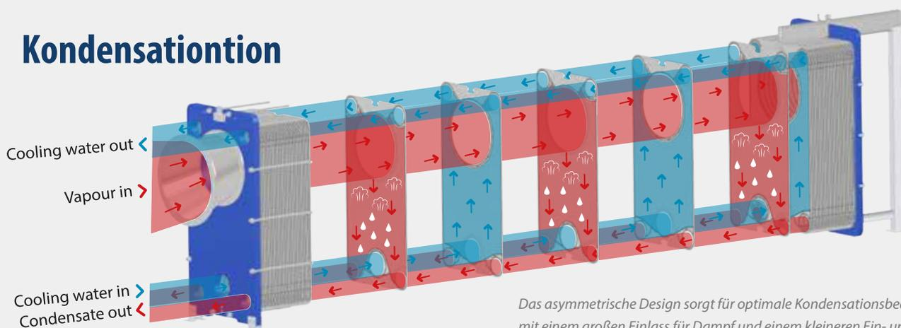
Das asymmetrische Design sorgt für optimale Kondensationsbedingungen, mit einem großen Einlass für Dampf und einem kleineren Ein- und Auslass für Kühlwasser und Kondensat.
